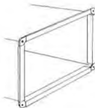
Схема: шинореечный тип соединения воздуховодов прямоугольного сечения
