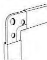
Схема: шинореечный тип соединения воздуховодов прямоугольного сечения
